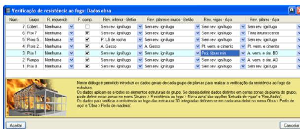
**CYPECAD** permite introduzir os dados gerais de cada grupo de pisos (resistência requerida, laje com função de compartimentação ou sem ela, e revestimento dos elementos construtivos) para realizar a verificação da resistência ao fogo da estrutura.
